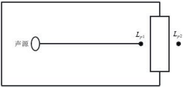
图 5.2-38 室内声源等效为室外声源图例
